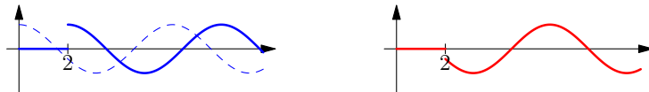
FIGURE 61.2 – Le graphe de la fonction t \mapsto \cos(t - 2)\mathcal{U}(t - 2) et t \mapsto \cos(t)\mathcal{U}(t - 2) . On dit que t \mapsto \cos(t - 2)\mathcal{U}(t - 2) est « en retard » sur \cos(t)\mathcal{U}(t) (en pointillé sur le graphe de gauche)
